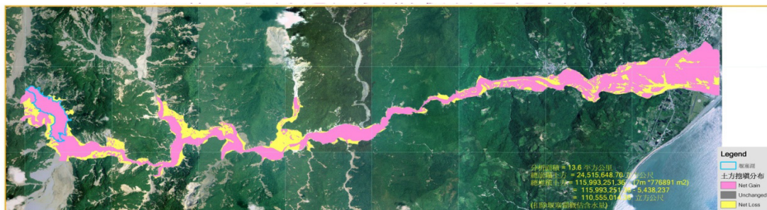
圖 19 太麻里溪風災前後河道挖填方圖
